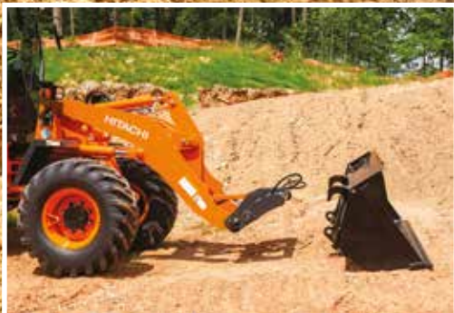
Le raccord rapide universel permet une transition en douceur (ZW80-5b).
