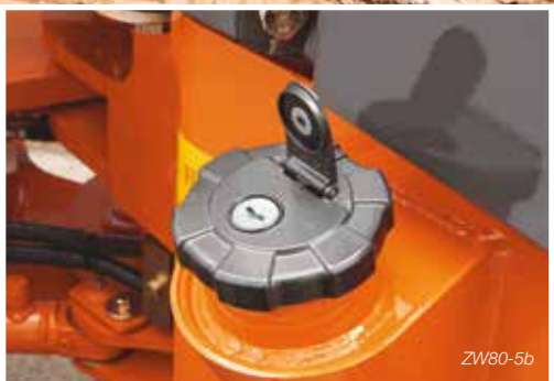
Le bouchon de réservoir et le couvercle du moteur peuvent être verrouillés avec la clé.
