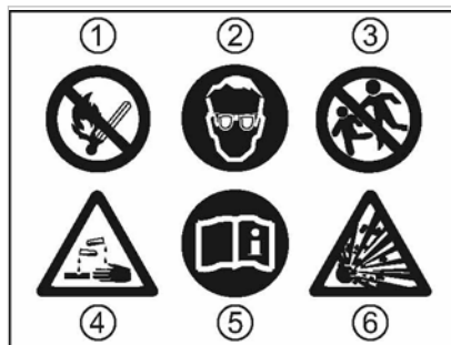
Abb. 57 Sicherheitszeichen-Warnaufkleber auf der Batterie
