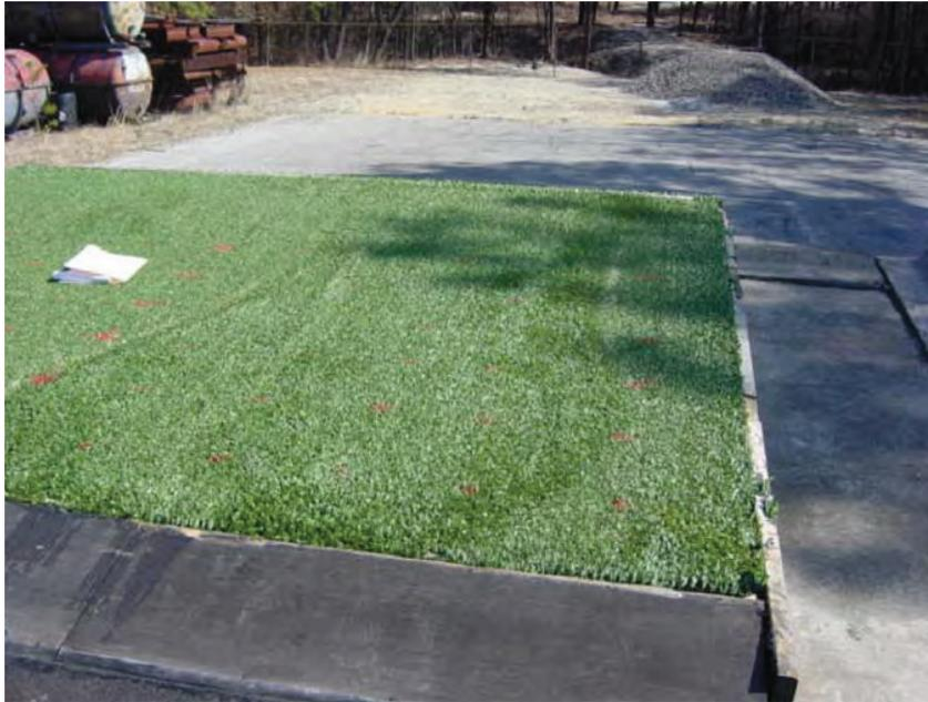
FIGURE C-53. TEST 8—1.5-INCH FIBER TEST PLOT AFTER TESTS
