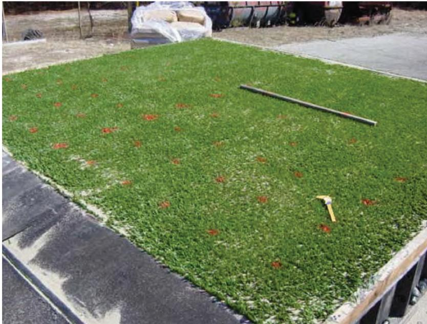
FIGURE C-50. THE 1.5-INCH FIBER TEST PLOT
